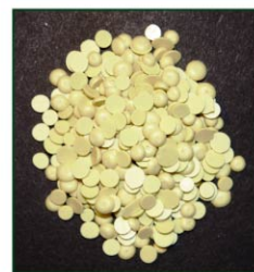
含有少量黏土的硫磺颗粒,有助于分散和氧化。
