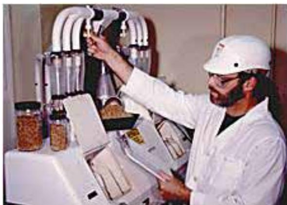
Определение содержания белка в образцах зерна.
