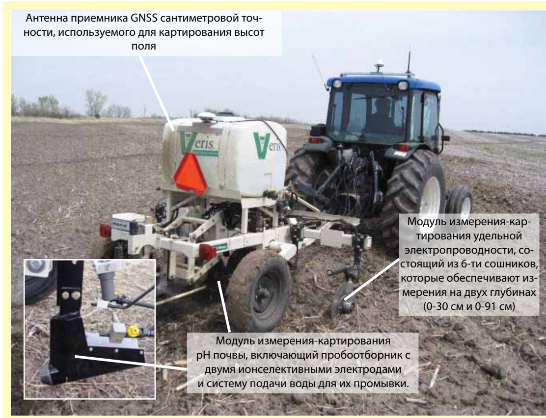
Рис. 3. Передвижная сенсорная платформа Veris® с блоками измерения-картирования удельной электропроводности и pH почвы («Верис Технолоджис, Инк.», г. Салина, штат Канзас, США), оборудованная приемником GNSS сантиметровой точности Trimble AgGPS® 442 («Тримбл Навигейшн Лтд.», г. Саннивейл, штат Калифорния, США).
