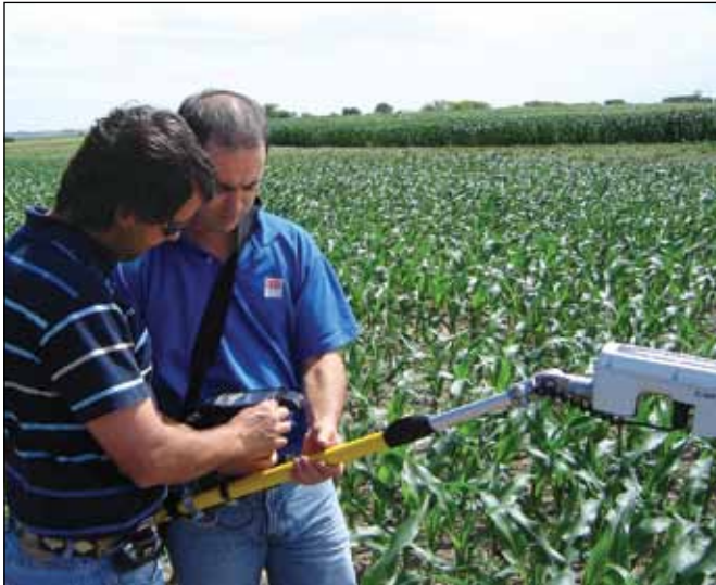
Автор (справа) и А. Бианчини (AAPRESID) проверяют результаты определения индекса NDVI в посевах кукурузы с помощью сенсора GreenSeeker.
