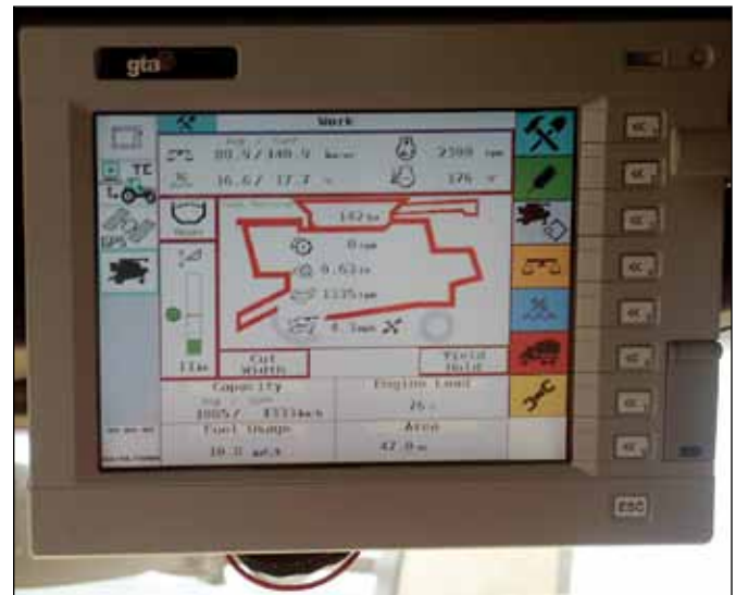
Пример дисплея для точного земледелия, установленного в кабине и информирующего оператора в режиме реального времени о рабочих параметрах и возможности получения различных данных.
