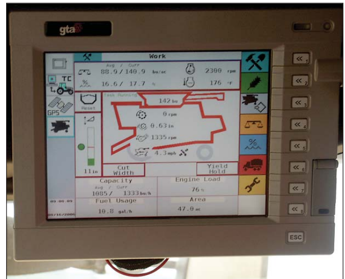
Посев с использованием системы автоматического вождения
