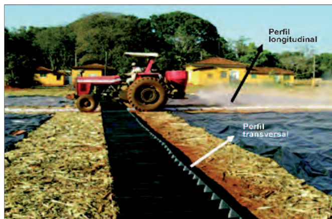
Foto 1. Formas de evaluación del perfil transversal y longitudinal para determinar la calidad de distribución de enmiendas y fertilizantes.
