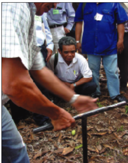
Foto 3.- Toma de muestras para caracterización del perfil.
