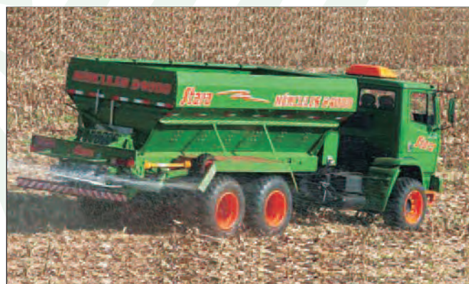
Foto 4. Detalle del equipo Hércules 24 000, de la Empresa Stara, con un mecanismo dosificador volumétrico tipo estera central y con un mecanismo distribuidor centrífugo con doble disco.
