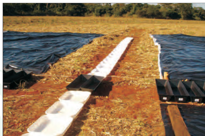
Foto 3. Detalle de la instalación de los colectores para recepción de muestras del perfil longitudinal.
