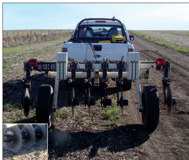
Figura 1. Equipo Veris 3100 montado detrás de una camioneta y equipado con un GPS Trimble®.
