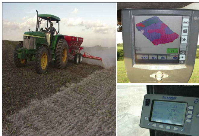
Figura 2. Aplicador a tasa variada de correctivos de suelo (izquierda), y monitores de cosecha y de aplicación por sitio-específico utilizados en el proyecto.
