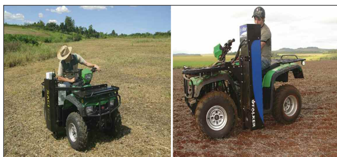
Figura 3. Extractor automático de suelo y penetrómetro adaptados a cuatriciclo utilizados en el Proyecto AP, Paraguay.
