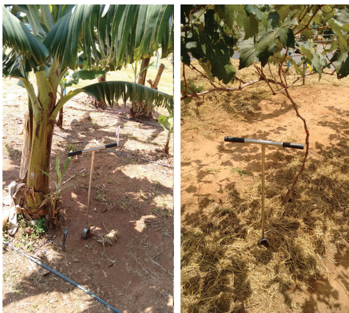
Figura 2. Amostragem de solo em pomar de banana ‘Prata’ e de uva ‘Niágara Rosada’.
