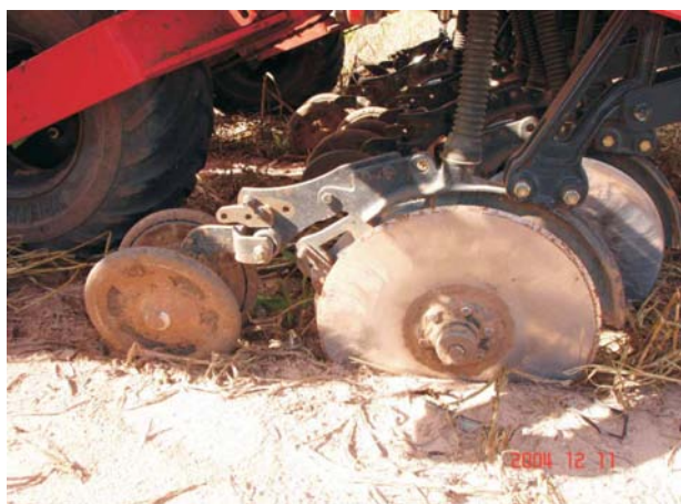
Figura 23. Detalhe dos compactadores adaptados à semeadora/adubadora para evitar a mistura do adubo com a semente.
