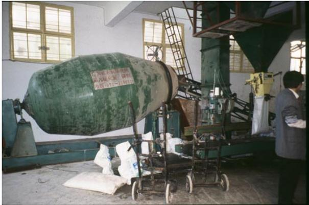
在江西宁都的一个复混肥厂中，用于生产散装干粒混合(BB)肥的混合器
