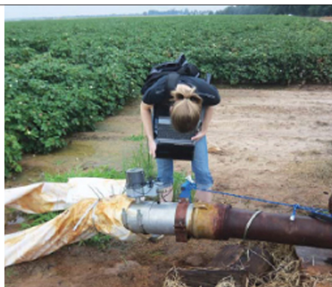
图 3 左图是自动取样机在阿肯色州阿特金斯发生径流时采集水样, 右图是阿肯色州迪马斯用于灌溉水输入的水流测试仪。
