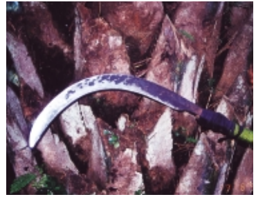
Egrek panen yang dibuat secara lokal dari bekas pegas truk.
