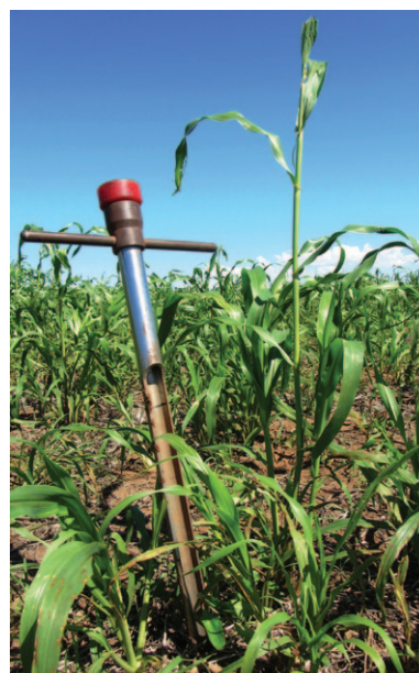
Figura 4. Sonda manual para coleta de amostras de solo. A coleta manual permite obter amostras com boa qualidade e oferece flexibilidade quanto ao momento de entrada no campo.
